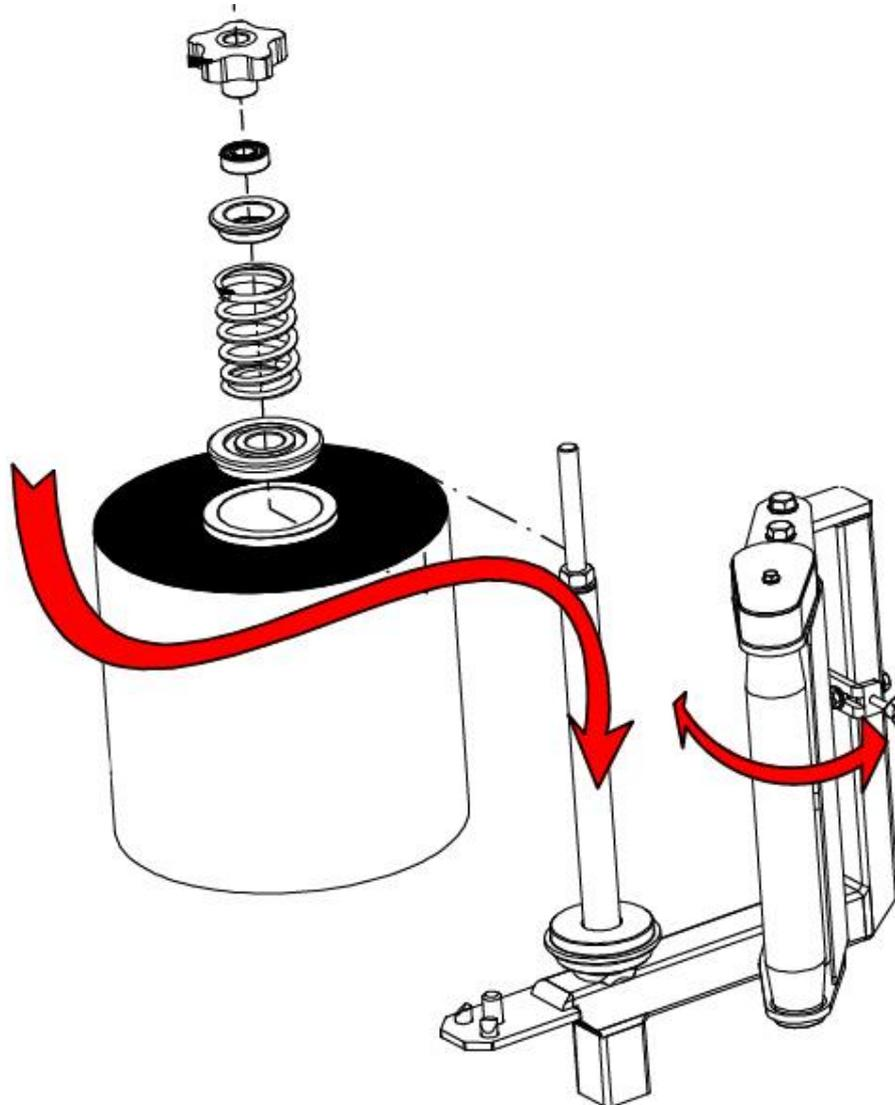
Per aumentare la frenatura del film e di conseguenza la sua stiratura, agire in senso orario sulla manopola nera posta sul perno al di sopra del rotolo stesso. Per diminuire la frenatura agire sulla manopola in senso antiorario.
